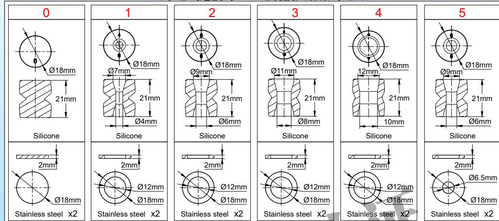
\*\* 用于圆形的或扁平电缆的M25 电缆接头后缀的定义
