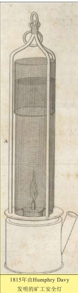
因油灯火焰而引致在矿井中的沼气爆炸，导致了很多意外事故及造成数百人死亡。这样的爆炸有双重危险：沼气和煤尘。当甲烷爆炸，爆炸经常会由最初的爆炸导致煤尘团燃烧，而煤尘团燃烧会产生更剧烈的粉尘爆炸（尘末爆炸）。
